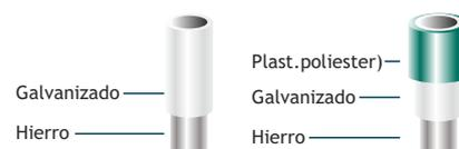
El recubrimiento es de poliéster anticorrosión con un mínimo de 120 micras.
